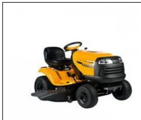
**Identification du risque :** La conduite de carburant des tracteurs touchés n'a pas été acheminée derrière le protecteur du réservoir, ce qui pourrait la faire entrer en contact avec la courroie de transmission et y exercer un frottement. Si cela se produit, du carburant pourrait s'échapper de la conduite et présenter un risque d'incendie. Aucun cas de blessure n'a été signalé.
